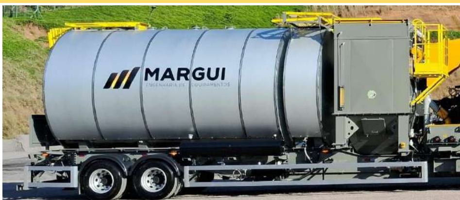
Tanque de 35.000L para asfalto e 5.000L para combustível.
