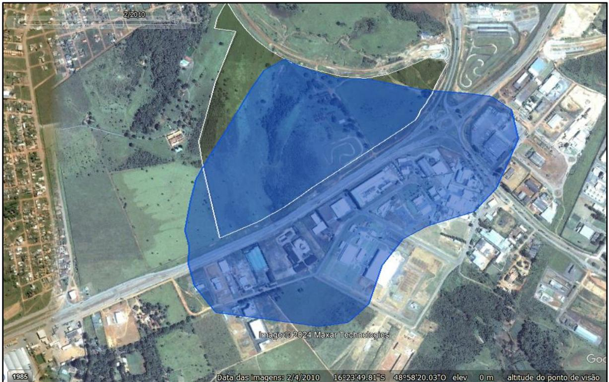
**Figura 10.** Imagem de satélite de 2010, antes do início das obras de construção do Centro de Eventos de Anápolis, evidenciando a existência de degradação no local com o direcionamento do fluxo da drenagem pluvial de uma bacia de contribuição de mais de 120 ha. Fonte: Google Earth.
