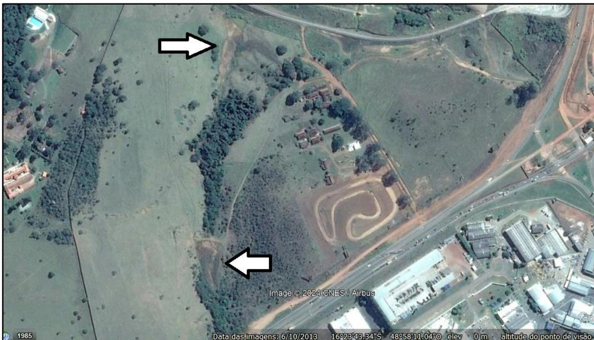
**Figura 12.** Reservatórios decorrentes de barramento do curso d'água natural já completamente assoreados, antes mesmo do início da construção do Centro de Convenções de Anápolis por parte da GOINFRA. Fonte: Google Eart.
