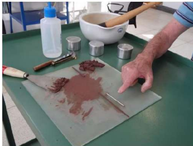
Figura 5 - Exemplo de verificação com o gabarito do ensaio de LP Fonte – Autor
