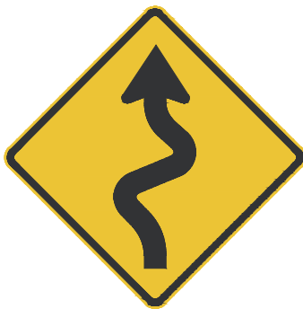
Dimensões: 1.00 x 1.00 m Status: Implementar Chapa: Aço 16
