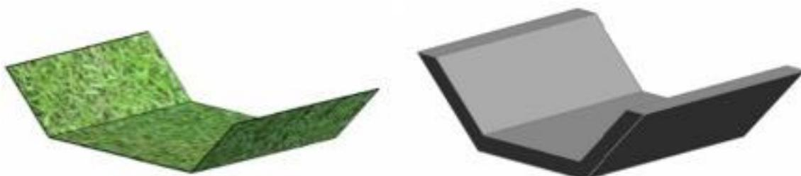
Figura 17-15 – Valetas de proteção em grama e em concreto – Perspectiva
