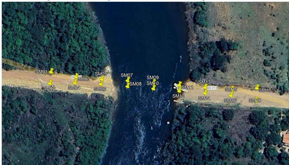
Figura 94 – Locação dos furos de sondagens de OAE
