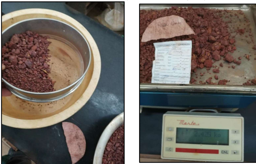
Figura 11 e 12 - Ilustração de etapa do ensaio de desgaste por abrasão Los Angeles
