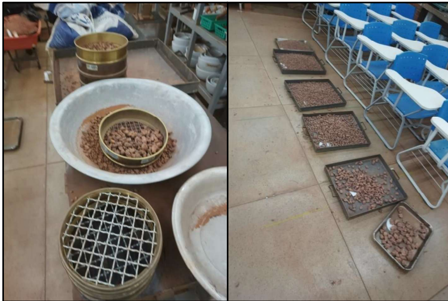
Figura 01 e 02 – Ilustra a etapa de peneiramento e análise granulométrica do agregado.
