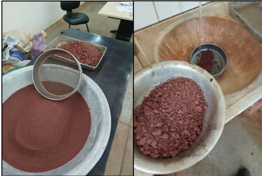
Figura 09 e 10 - Ilustração de etapa do ensaio de desgaste por Abrasão Los Angeles.
