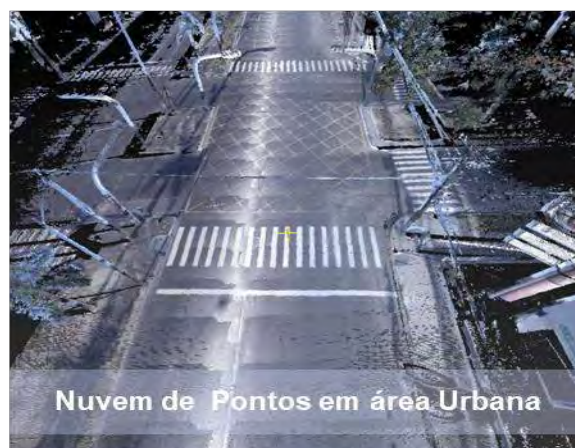
Figura 58 - Nuvem de Pontos Gerada pelo Equipamento
