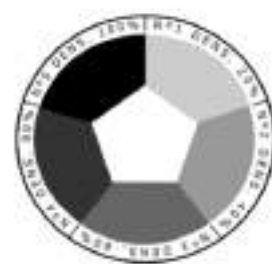
Figura 39 - Monitoramento utilizando a Escala de Ringelmann
