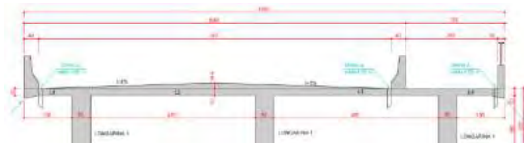
Figura 21 - Seção Transversal-tipo proposta para as Pontes
