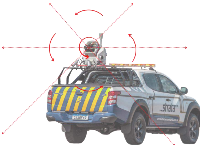
Figura 59 - Princípio de Funcionamento do Pegasus Two Ultimate
