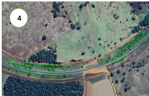
Figura 2 – Exemplos de delimitação para CAI – Incorretas (imagens 1 e 3) e corretas (2 e 4). Fonte: Adaptado do acervo de obras da GOINFRA.
