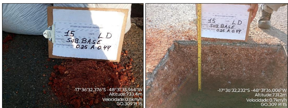
Figura 11 - Registro fotográfico de argila arenosa avermelhada na Sub-base (PI-15).
