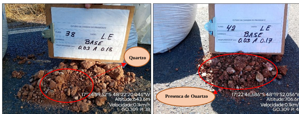
Figura 9 - Registro fotográfico Solo com composição quartzosa (PI-38 e PI-42).
