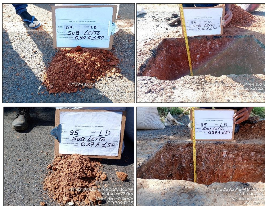
Figura 12 - Registro fotográfico do solo de fundação (PI-09 e PI-25).
