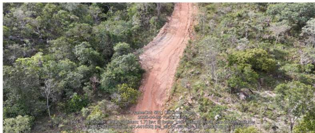
Figura 51 – SUCOS erosivos na rampa posterior ao curso d'água, carreando material para o talvegue.
