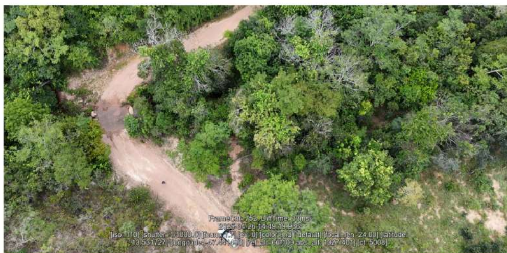
Figura 48 – Marcas de compactação do leito do curso d'água devido a passagem de veículos no talvegue desprotegido, além da contaminação da água por fluidos veiculares.
