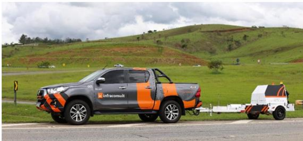
Figura 3 - Veículo Equipado com FWD
