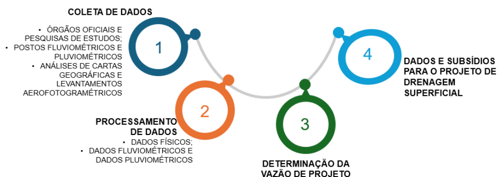
Figura 19 — Fluxograma de desenvolvimento dos Estudos Hidrológicos
