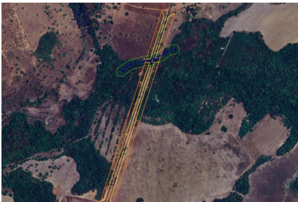
Figura 8. Proteção da vegetação na faixa de domínio para interligação do corredor ecológico natural à passagem de fauna. Fonte: Elaborada pela equipe da Gerência Ambiental da GOINFRA.
