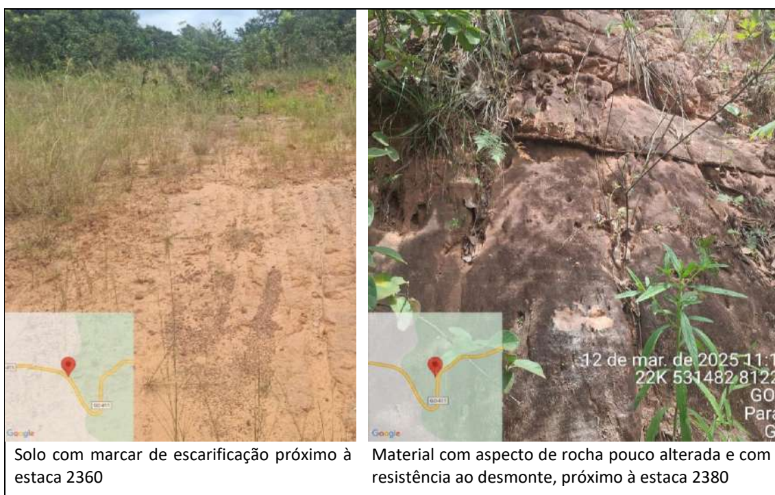
Figura 2: Imagens de caracterização do solo entre as estacas 2360 e 2380.
