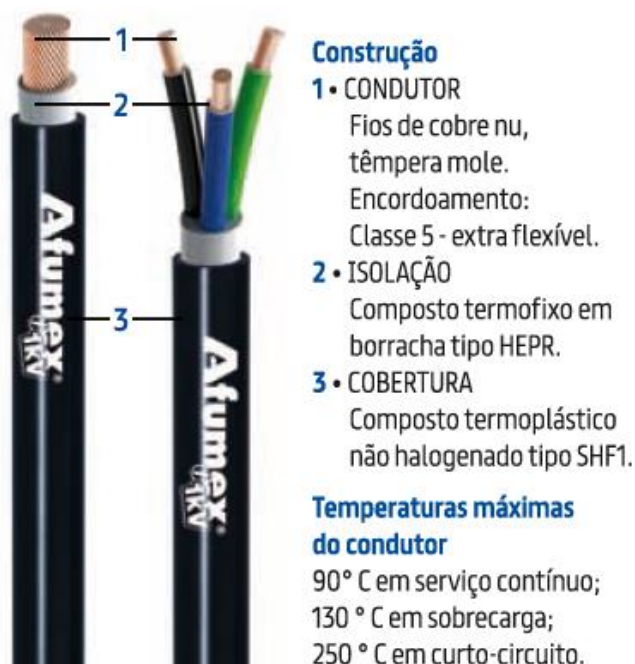
Figura 1 - Cabo com isolamento em ERP/HEPR 90°C de referência (Ref. Prysmian)
