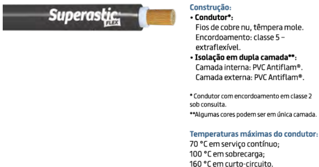
Figura 2 - Cabo com isolamento em PVC 70°C de referência (Ref. Prysmian)
