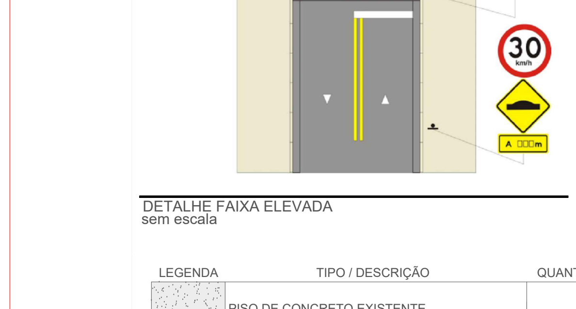
DETALHE FAIXA ELEVADA sem escala
