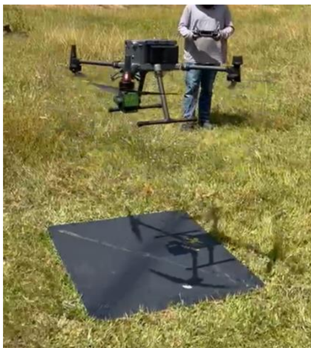
Figura 13: Execução de levantamento utilizando perfilamento a laser a partir do marco M03.
