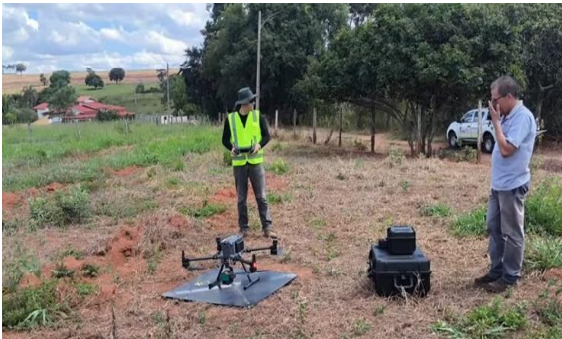
Figura 12: Execução de levantamento utilizando perfilamento a laser a partir do marco M03.
