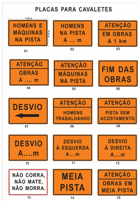
Figura 28. Exemplo de sinalização vertical em obras.
