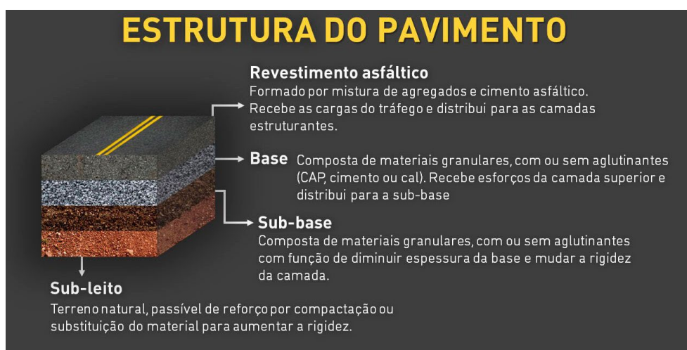
Figura 31. Estrutura do pavimento. Fonte: Triunfo.
