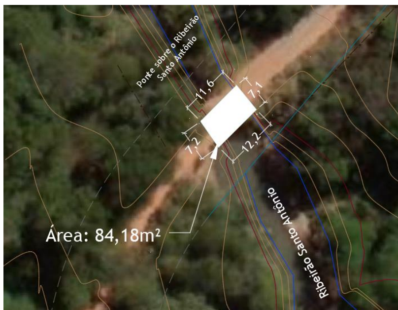
Figura 78: Dimensões do Pontilhão existente
