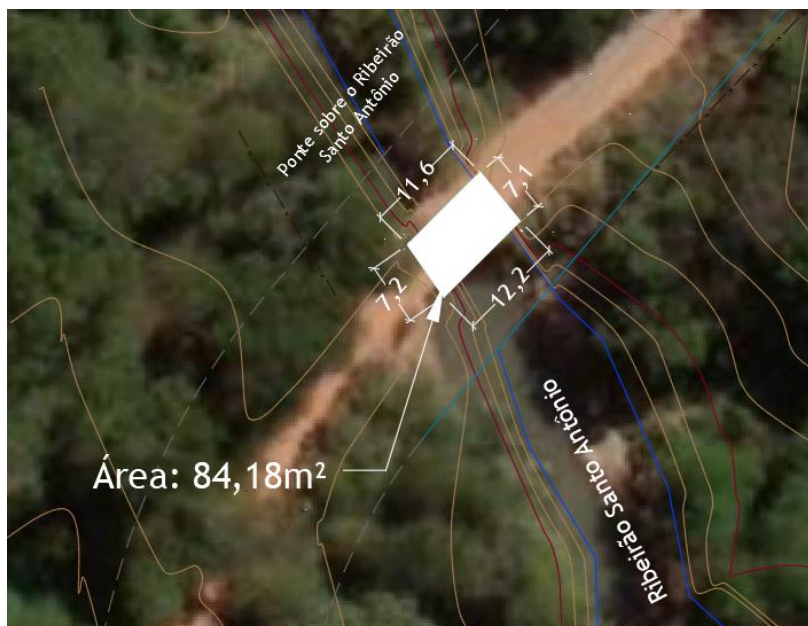
Figura 5: Dimensões do Pontilhão existente
