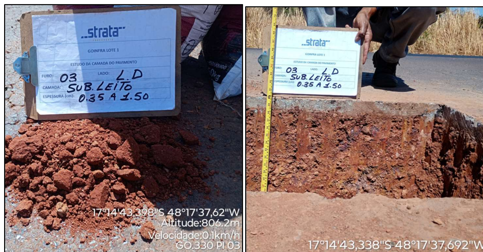
Figura 10 - Registro fotográfico do solo de fundação (solo argiloso e silte).
