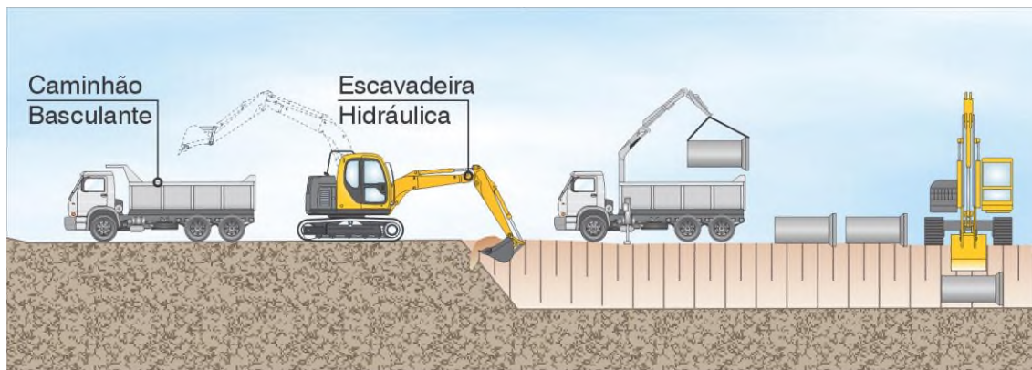
Figura 40: Ilustração da metodologia executiva da colocação de bueiros - Fonte: O Autor.
