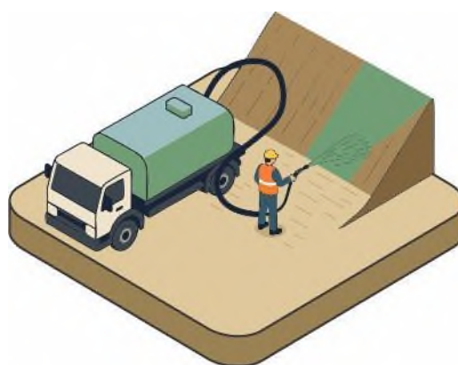
FASE 5: APLICAÇÃO DA HIDROSSEMEADURA
