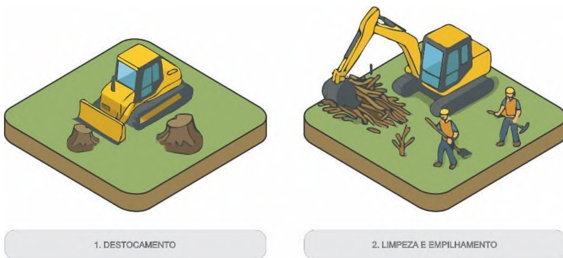
Figura 35: Destocamento, limpeza e empilhamento - Fonte: O Autor.
