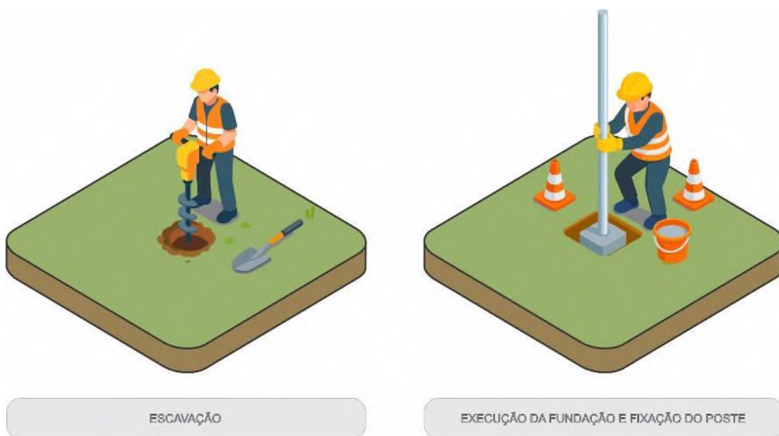
Figura 44 - Escavação, Execução da fundação de concreto e fixação do Poste metálico - Fonte: O Autor.
