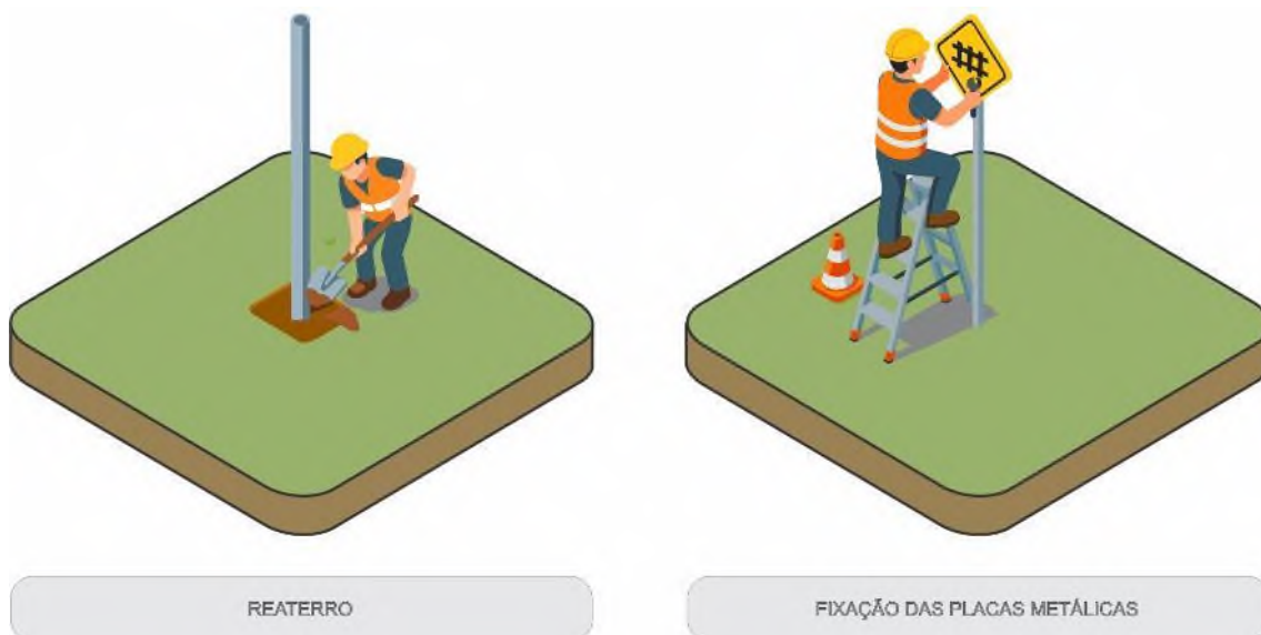
Figura 45 - Reaterro e Fixação de Placa em Suporte metálico - Fonte: O Autor
