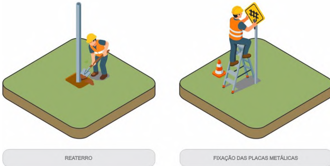
Figura 38 - Reaterro e Fixação de Placa em Suporte metálico - Fonte: O Autor
