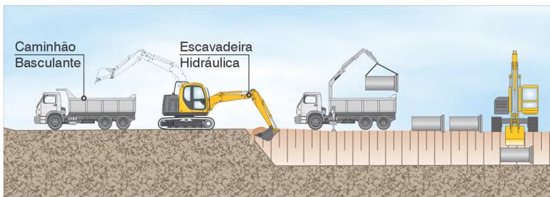
Figura 33: Ilustração da metodologia executiva da colocação de bueiros - Fonte: O Autor.
