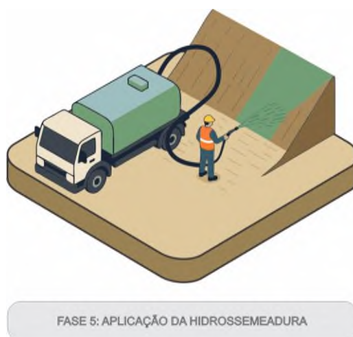
Figura 36 - Aplicação da Hidrossemeadura - Fonte: O Autor
