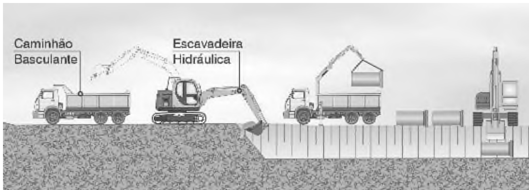
Figura 40: Ilustração da metodologia executiva da colocação de bueiros - Fonte: O Autor.
