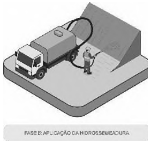
Figura 43 - Aplicação da Hidrossemeadura - Fonte: O Autor
