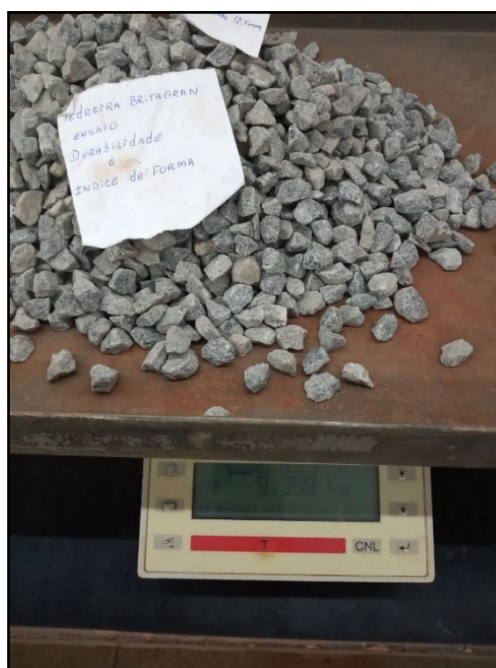
Figura 7- Preparação da amostra, pesagem das frações.
