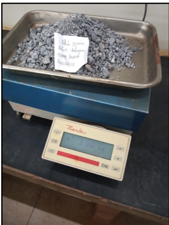
Foto 4: Pesagem do agregado seco em estufa e retido na peneira 1,7mm
