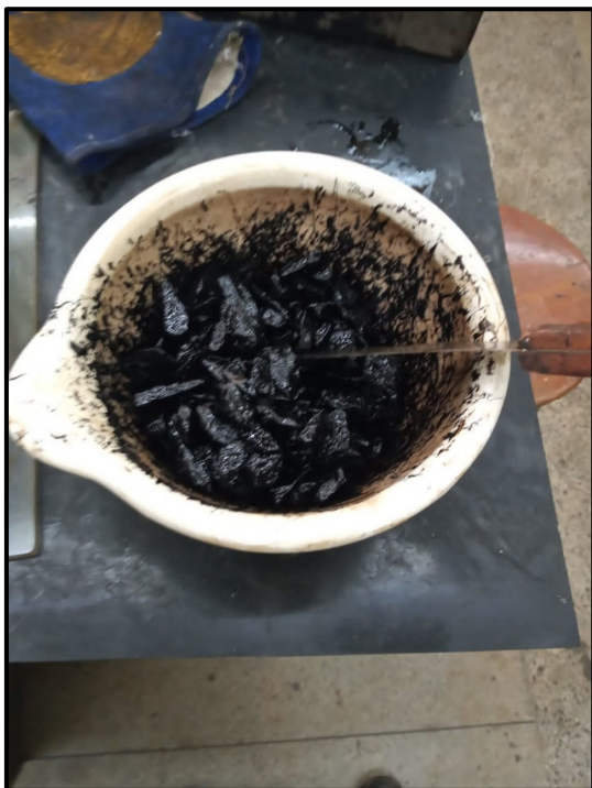
Foto 5: Processo de mistura do ligante com o agregado
