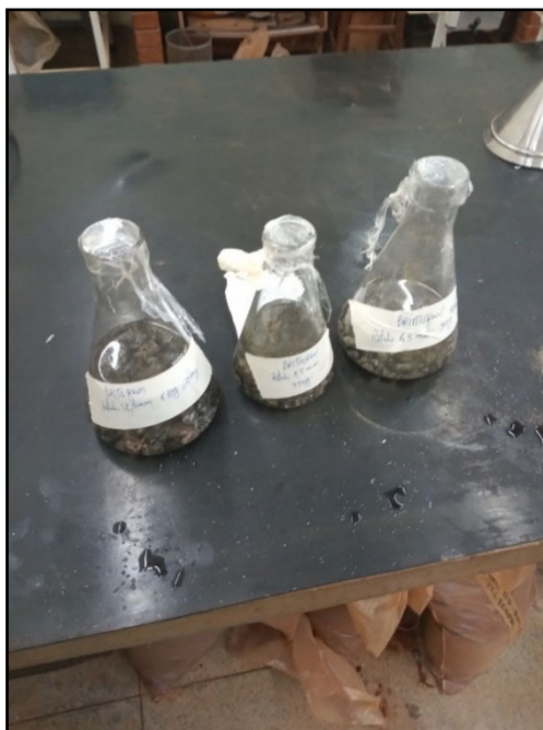
Figura 10- Processo de imersão em sulfato de sódio
