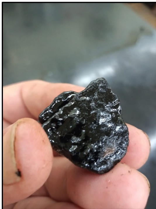
Foto 6: Avaliação da adesividade do agregado ao ligante
