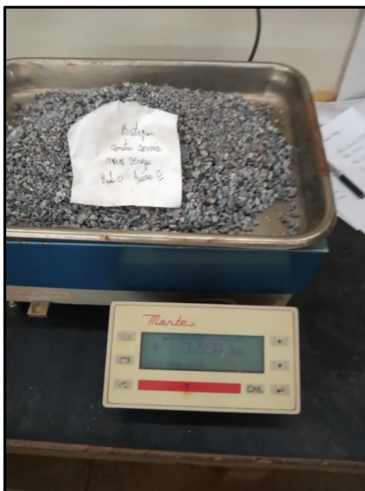
Foto 4: Pesagem do agregado seco em estufa e retido na peneira 1,7mm
