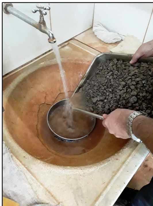
Foto 3: Processo de lavagem do agregado após abrasão
