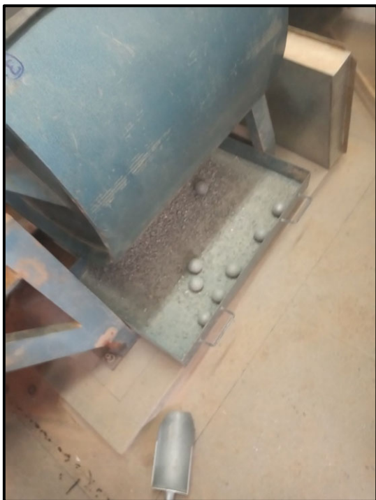
Foto 2: Abrasão do Agregado no Aparelho
