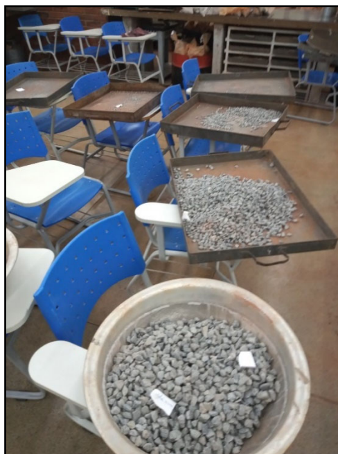
Figura 6- Preparação da Amostra, etapa de peneiramento.
