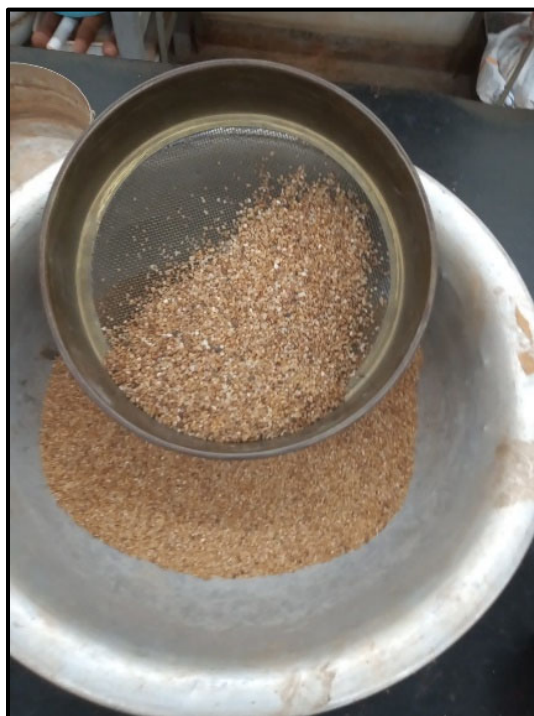
Foto 11: peneiramento e análise granulométrica do agregado
