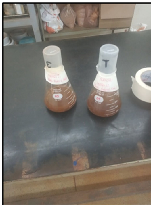
Foto 13: realização do ensaio de impurezas orgânicas
