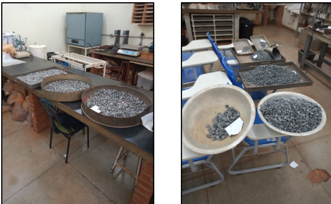
Foto 1: etapa de peneiramento e análise granulométrica dos agregados.
