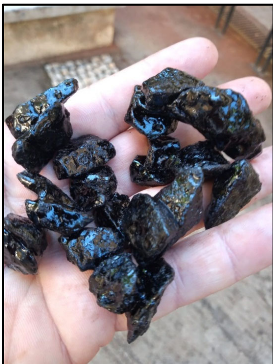
Foto 7: Avaliação do processo de adesividade após 72 horas
