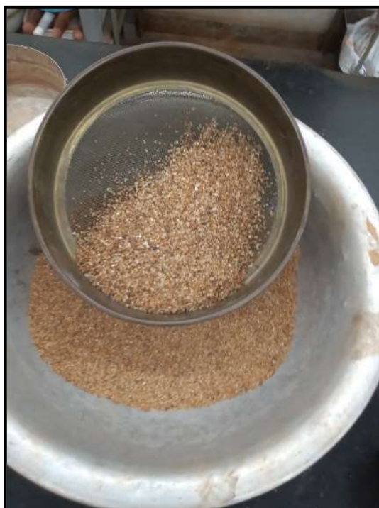
Foto 14: peneiramento e análise granulométrica do agregado
