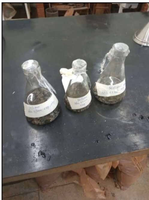
Figura 16- Processo de imersão em sulfato de sódio
