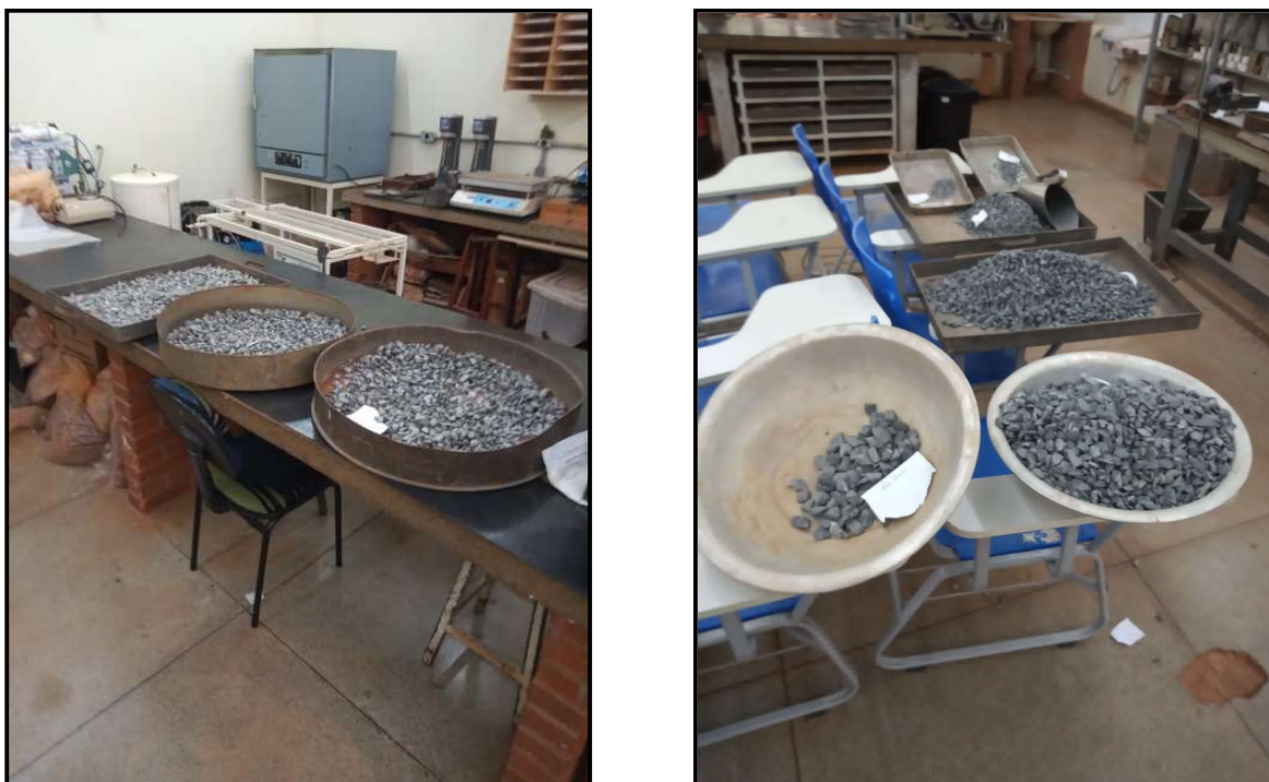
Foto 4: etapa de peneiramento e análise granulométrica dos agregados.
