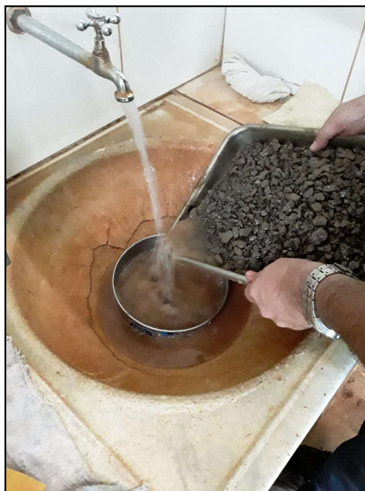
Foto 6: Processo de lavagem do agregado após abrasão
