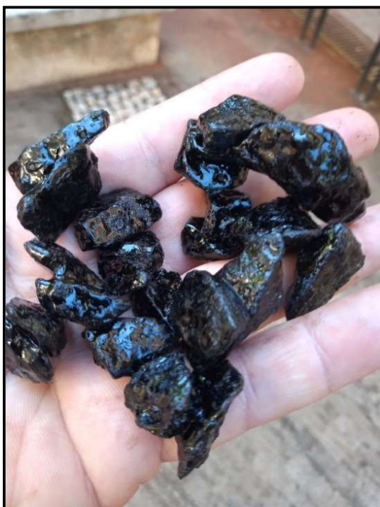
Foto 10: Avaliação do processo de adesividade após 72 horas
