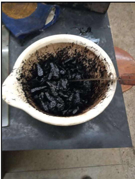
Foto 8: Processo de mistura do ligante com o agregado
