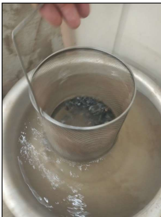
Figura 17- Processo de imersão em sulfato de bário e água quente
