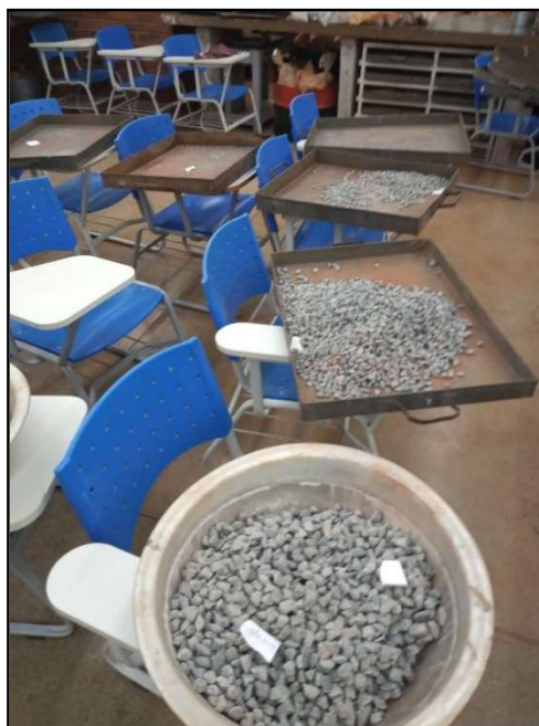
Figura 12- Preparação da Amostra, etapa de peneiramento.
