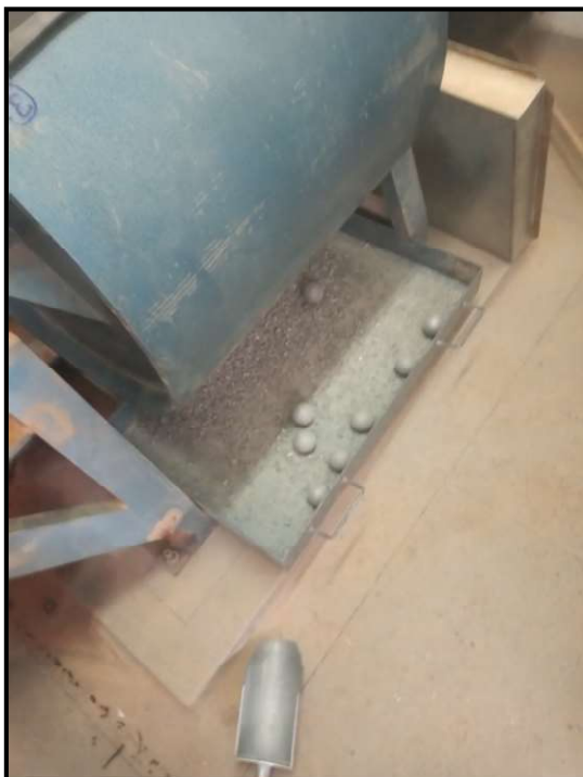
Foto 5: Abrasão do Agregado no Aparelho
