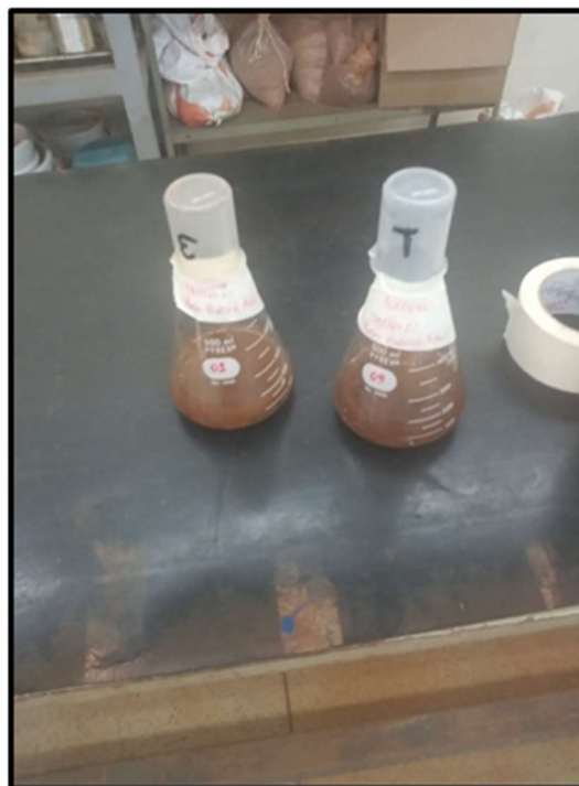
Foto 16: realização do ensaio de impurezas orgânicas
