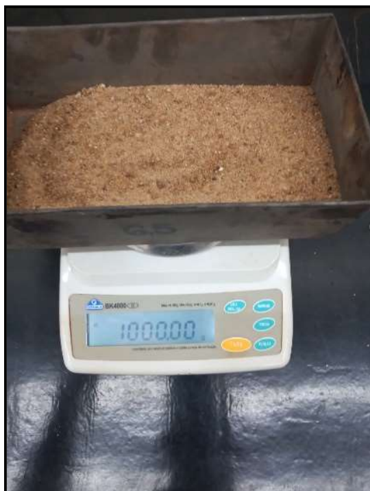
Foto 14: peneiramento e análise granulométrica do agregado
