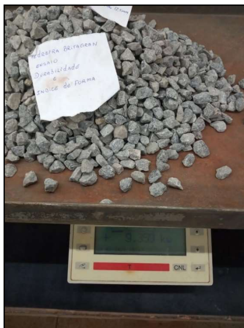
Figura 13- Preparação da amostra, pesagem das frações.
