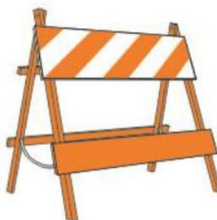
Figura 32: Barreira Móvel com Cavalete Articulado
