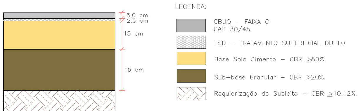
Figura 47 - Esquema da seção transversal tipo de pavimentação
