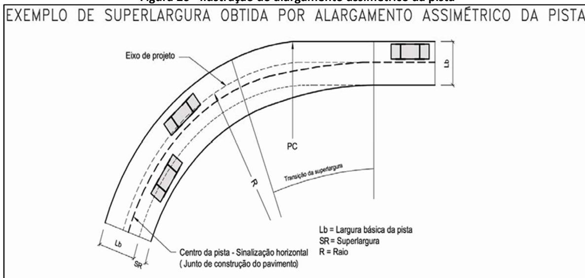
Figura 26 - Ilustração do alargamento assimétrico da pista
